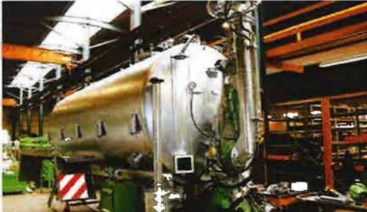
Ramię załadawcze jumbo z napełniaczem turbo po montażu
