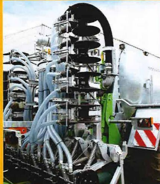
Maszyna Modulo2 z aplikatorem solodisc gotowa do odbioru
