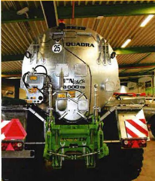
Podnośnik 4-punktowy tylny i punkty montażowe u góry zbiornika stanowią przygotowanie do osprzętu tylnego, jak np. rampa z wężami wleczonymi
