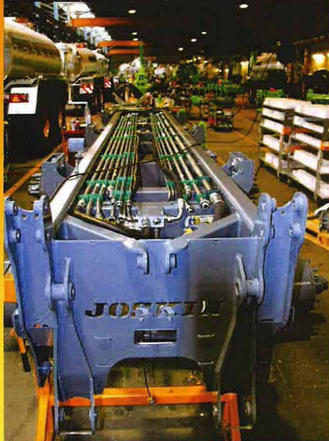
Na ramie Euroliner instaluje się wyposażenie przed montażem zbiornika
